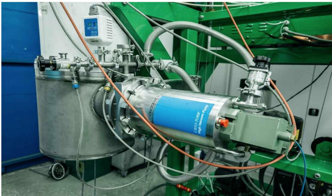
Figura 8. Acelerador de electrones de pulso, desarrollado por científicos de la Universidad, Politécnico de Tomsk [25]
