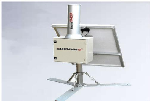
*SpectroTRACER es un sistema de medición de funcionamiento continuo para la detección específica de nucleidos del nivel más bajo de contaminación gamma en el aire y en líquidos (agua).*
