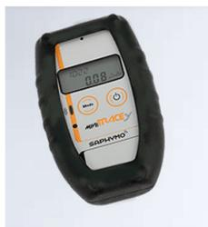
*El MiniTRACE es un medidor de topografía diseñado específicamente para la medición de radiaciones X y Gamma, así como para la mejora de la seguridad de los empleados en áreas controladas de centrales nucleares, instalaciones de reprocesamiento, centros de tratamiento y hospitales.*
