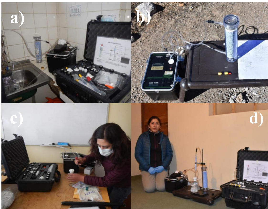
Fotografía 3.1 a y b) Ensamblaje del Equipo Detector Electrónico de Radón-222 'RAD-7 DURRIDGE', c y d) Capacitación de la Técnico Químico-Analista de la ABEN, en el uso, ensamblaje, instalación, y manejo del Equipo Detector Electrónico de Radón-222 'RAD-7 DURRIDGE'.
