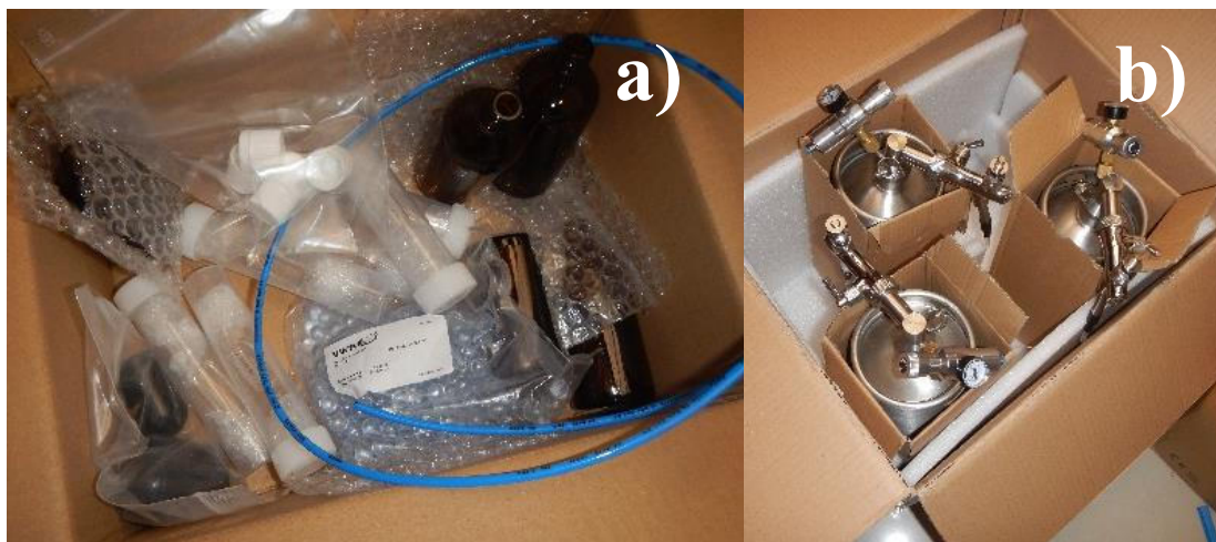
Fotografía 3.5 a) y b) Materiales de referencia para la calibración del Sistema Analizador Isotópico de Agua en fase Líquida PICARRO L2130-i.
