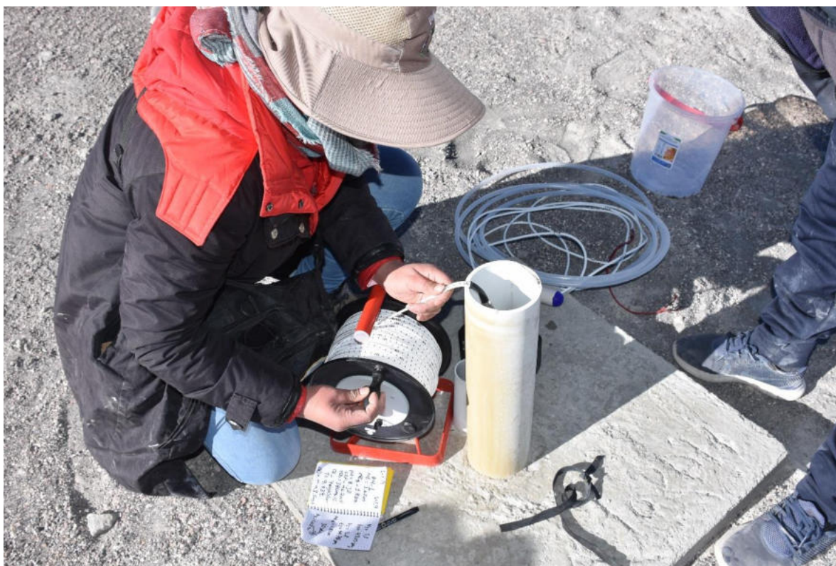
Misión Científica de Campo 2021: Mediciones in-situ en un piezómetro de monitoreo 'Zona Piloto Laguna Colorada'.
