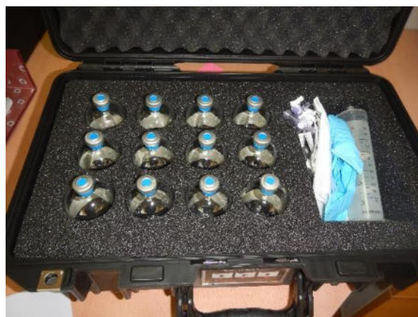
Fotografía 3.4 Kit de Muestreo para Carbono-14.
