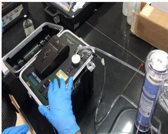
**Figura 2.** Montaje del equipo RAD-7 DURRIDGE, realizado por el equipo técnico de la ABEN. **Fuente:** ABEN
