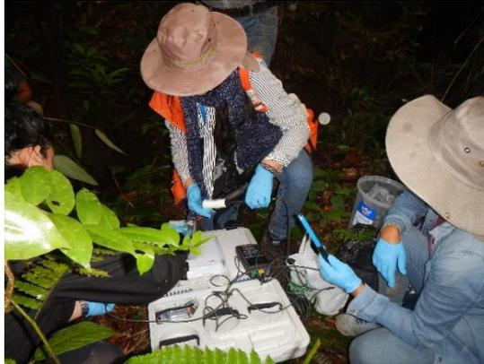
**Figura 4.** Especialistas de la ABEN realizando trabajo de campo para la medición de Radón-222. Foto: ABEN
