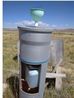
**Figura 7.** Toma de muestras de agua de lluvia por medio del colector por precipitación. **Foto:** ABEN
