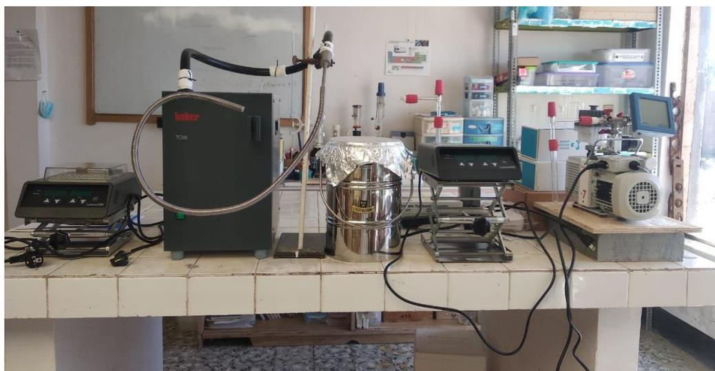
**Figura 3.** Sistema criogénico de extracción de agua. **Foto:** ABEN
