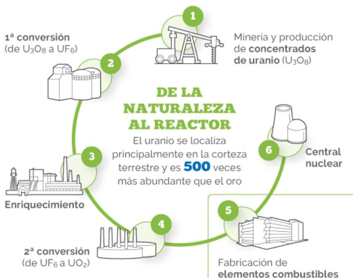
Figura 6. Ciclo de combustible nuclear. Fuente: [www.foronuclear.org](http://www.foronuclear.org)
