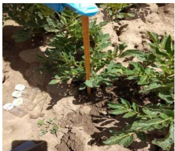
**Figura 9.** Toma de temperatura del suelo.
