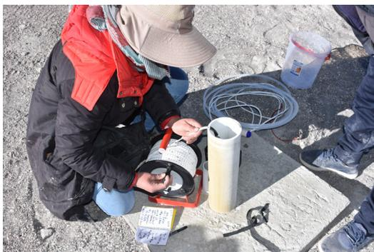
**Figura 5.** Misión Científica de Campo 2021: Mediciones in-situ en un piezómetro de monitoreo "Zona Piloto Laguna Colorada"
