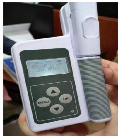
**Figura 5.** Equipo medidor de clorofila. **Fuente:** ABEN
