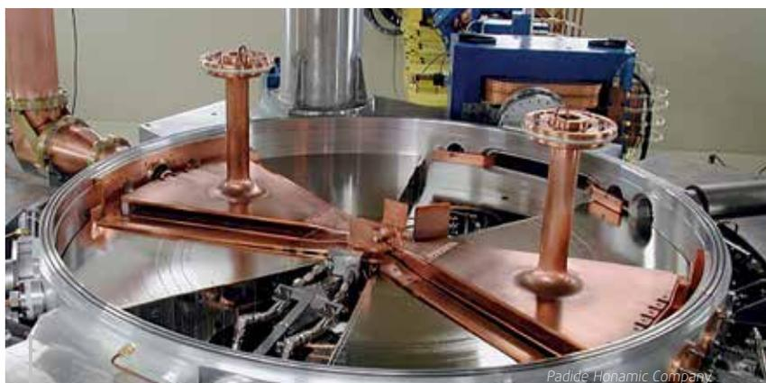
• Estructura interna de un Ciclotrón.
