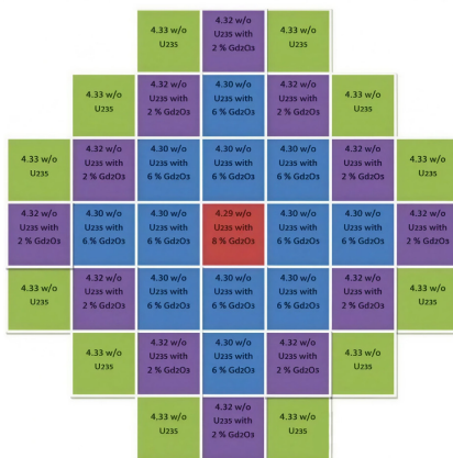
Figura 57. Esquema del núcleo del reactor NuScale, el enriquecimiento y composición mostrado está basado en la referencia del fabricante y no es necesariamente el usado por el fabricante
