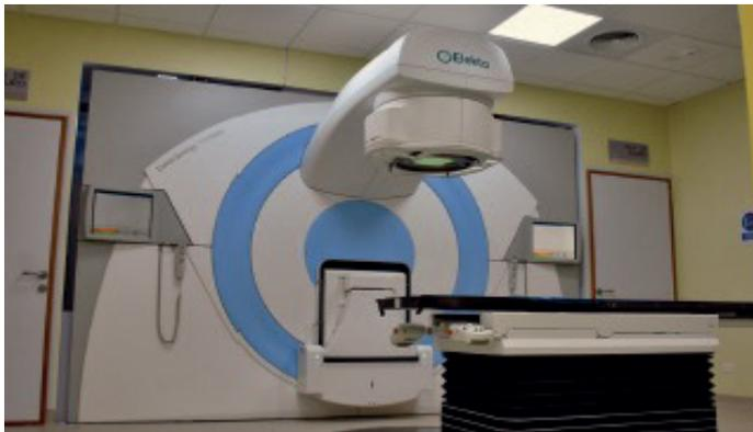
No dispone de ninguna fuente radiactiva, se producen radiaciones a partir de electrones acelerados por ondas electromagnéticas generadas en la propia unidad.
